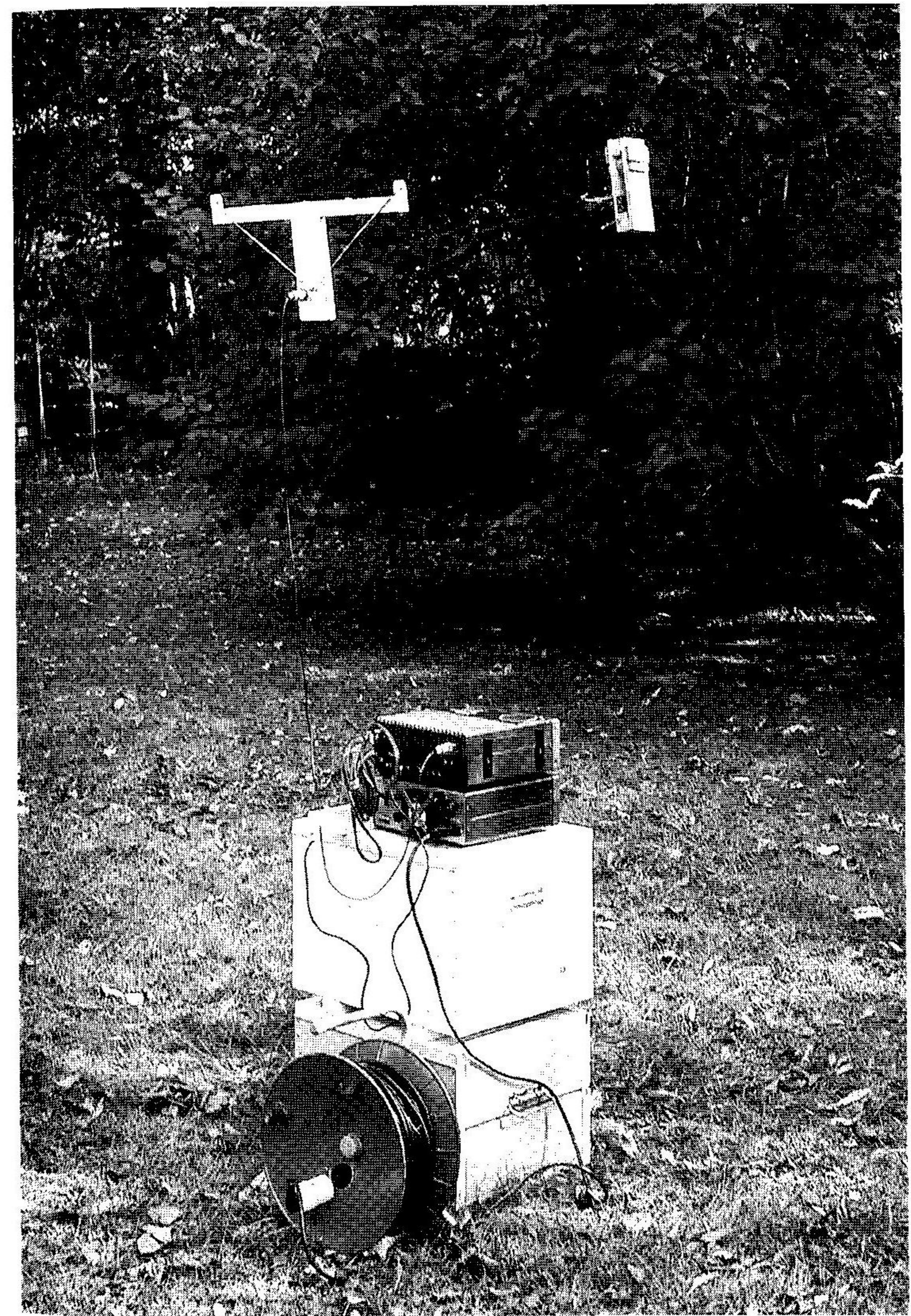
Resonanzmessung mit Transceiver, Koppelschleife und Strom-Meßgerät
